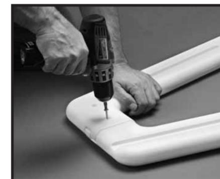
**Étape 1-4 :** Fixez les montants à l'aide de deux vis autotaraudeuses #10 x 1 1/4 po (une sur la marque désignée sur le montant intérieur et une sur le montant extérieur). Répétez la procédure pour l'autre montant de retour.
