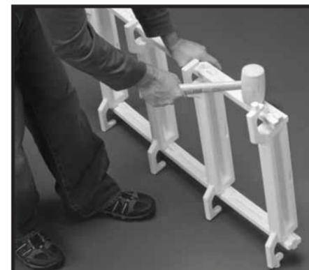
**Étape 3-4 :** Répétez l'étape 3-2 pour aligner les trous rectangulaires dans le raccord de marche restant avec les languettes sur les marches de glissière. Tournez l'échelle de glissière sur le côté et tapez le raccord de marche jusqu'à ce qu'il soit fermement enclenché.
