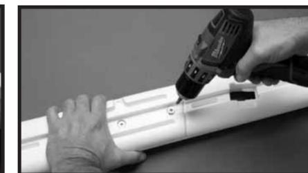
**Étape 1-2 :** Raccordez les montants supérieur et inférieur en vous servant de deux boulons #20 x 1/4 po x 7/8 po et de deux écrous hexagonaux 1/4-20. Répétez le processus pour assembler l'autre montant.
